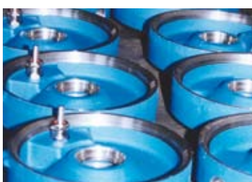
Lagerflansch mit eingebauter Dichtungssonde
